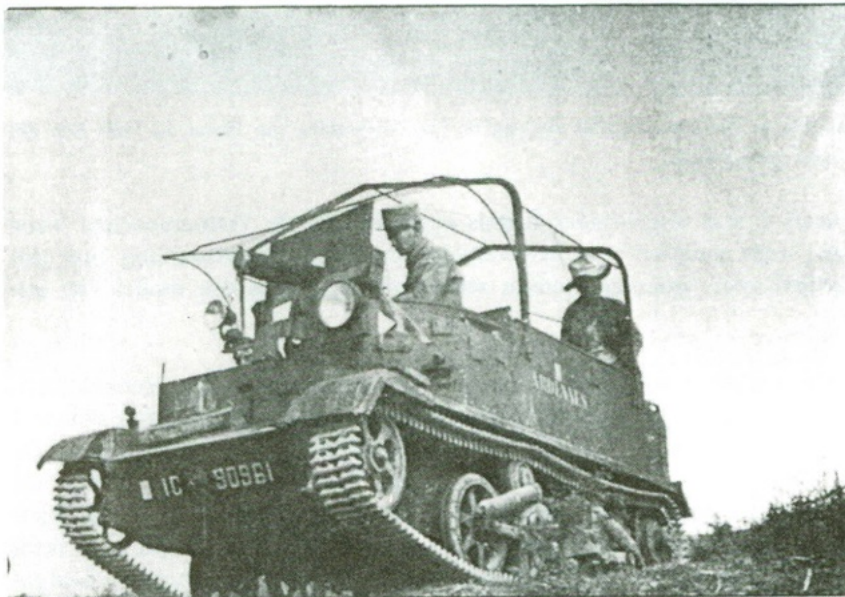
Een voormalige Britse Universal Carrier, uitgerust met een scherm van kippegaas tegen handgranaten en bewapend met een zware watergekoelde mitrailleur.
